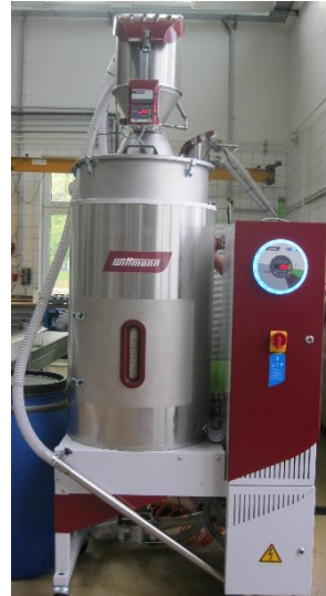
Dry-air dryer Wittmann Drymax Aton F120; 110 °C
